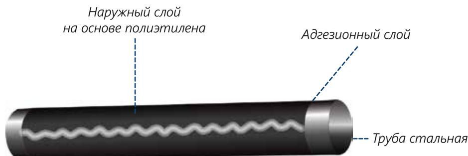
Трубы стальные диаметром от 108 до 1420 мм с наружным защитным антикоррозионным покрытием из двухслойного и трехслойного экструдированного полиэтиленового покрытия предназначены для строительства, реконструкции и ремонта магистральных нефте- и газопроводов, газоконденсатопроводов и технологических трубопроводов с температурой транспортируемого продукта до +80 °С.
