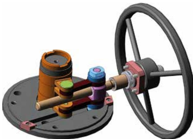
Усилие с маховика привода на шпindelь крана передается через рычажно-винтовой механизм.
