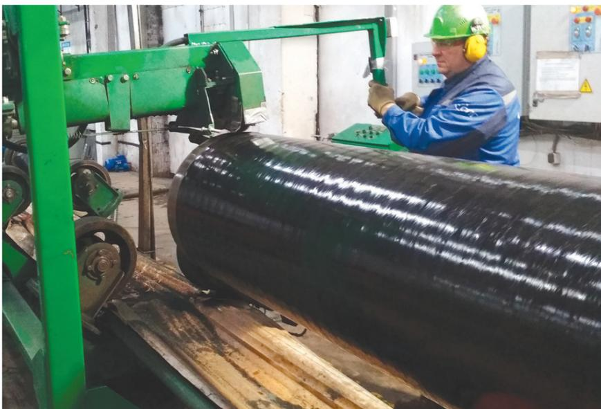
В конце 2019 года техническими службами Ижевского завода изоляции была проведена модернизация линии наружного покрытия. Результатом модернизации стало расширение линейки типоразмеров труб, на которые завод наносит наружное полиэтиленовое трехслойное и двухслойное покрытие.
